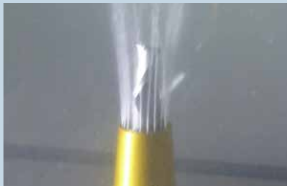
ノズル付きスリーブ遠心力により刃先までクーラントが届かない Slip-on sleeve with nozzles – ineffective cooling, coolant does not reach the cutting edges
