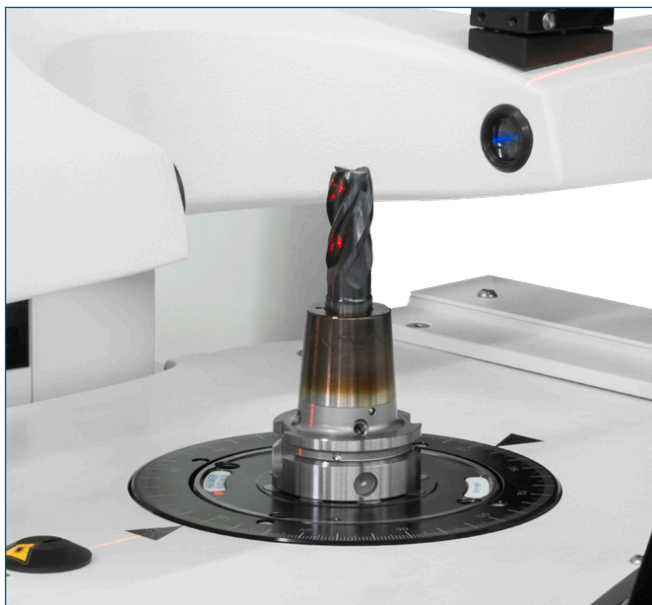
Medición sin contacto con una cámara de alta resolución y procesamiento digital de imágenes, incl. software de medición "Microvision" Medição sem contato com uma câmera de alta resolução e processamento de imagem digital, incl. software de medição „Microvision“
