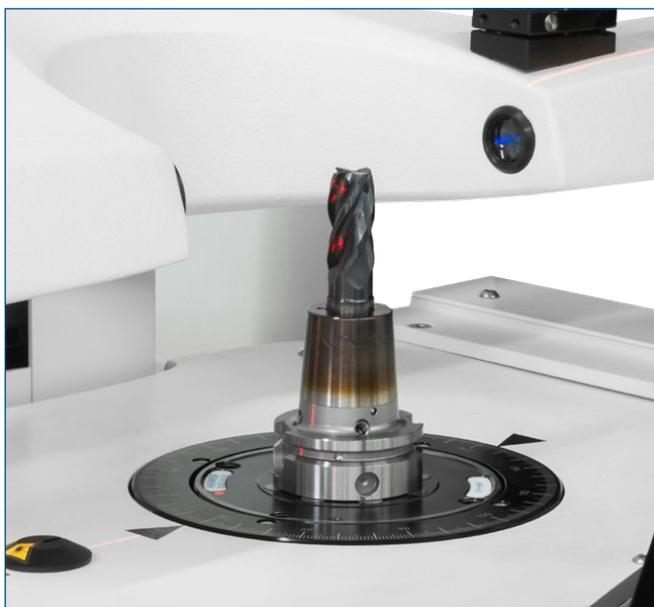
高解像度カメラとデジタル画像処理による非接触測定、測定ソフトウェア「Microvision」を含む
